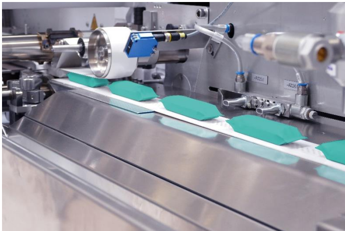
Bild 2: Theegarten-Pactec hat die ideale Lösung für das Heißsiegeln papierbasierter Verpackungen entwickelt – und zwar im Hochleistungsbereich. Damit wird auf der FPC5 eine Leistung von beeindruckenden 90 m/min erreicht. Das entspricht 600 größeren 40g Schokoladenriegeln pro Minute.
