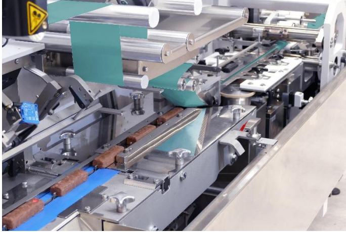
Bild 1: Theegarten-Pactec hat die FPC5 – eine modulare Hochleistungs-Verpackungsmaschine für Riegel- und Tafelprodukte in Schlauchbeutel – so weiterentwickelt, dass sie nun papierbasierte Packmittel verarbeiten kann.
